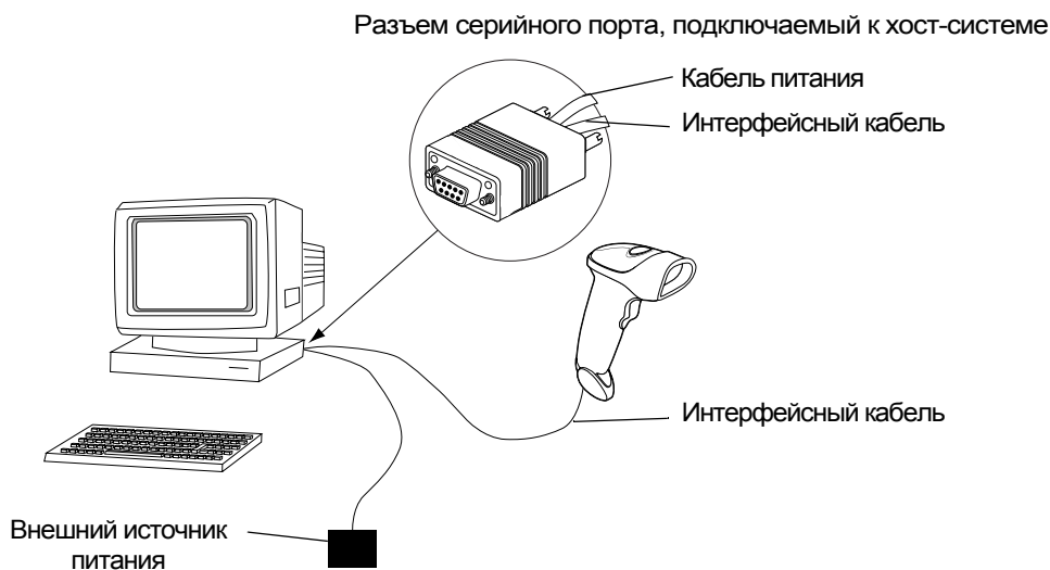
Рисунок 6-1 Прямое подключение посредством интерфейса RS-232
